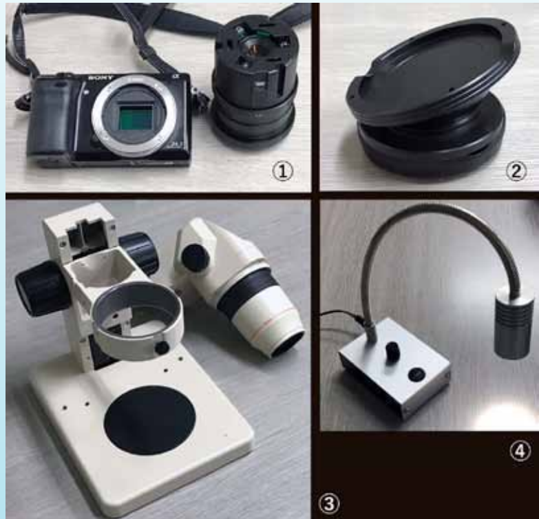
写真1: 撮影に必要なもの。①ミラーレスカメラとマクロレンズ。②カップステージ。③実体顕微鏡の架台。④照明。
