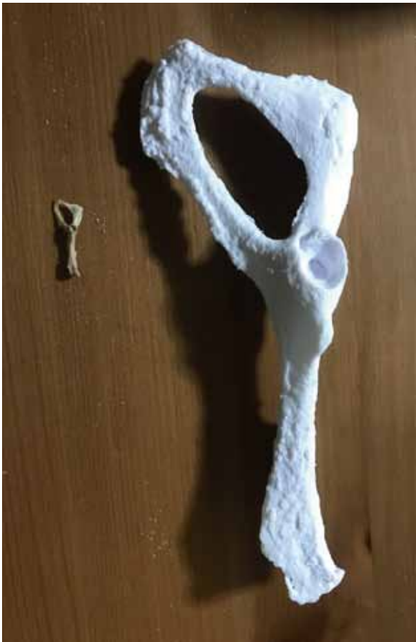
図2 アカネズミの骨盤 左が実物で右が出力品
